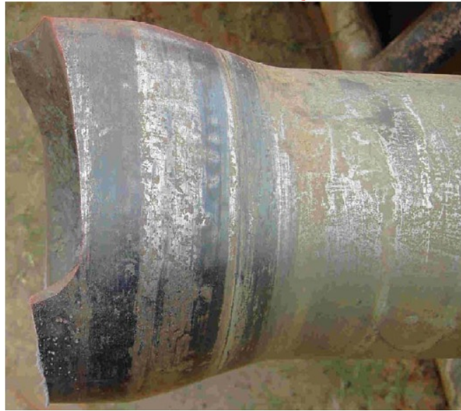
الشكل 16: انقطاع وصلة أنبوب الحفر نتيجة الاحتكاك
